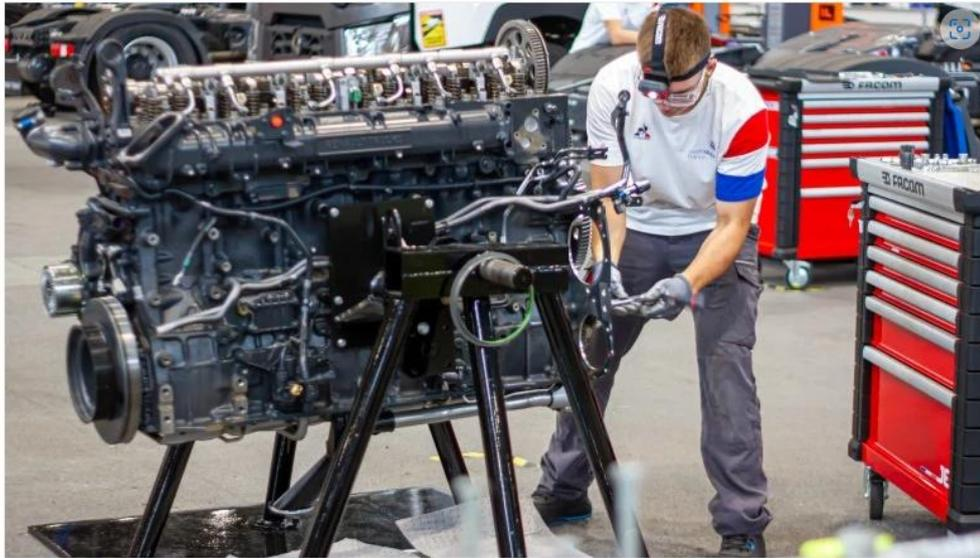
L'épreuve de mécanique consistait à changer la cylindrée du moteur (chemise, piston) avec de la métrologie pour vérifier si la pièce remplacée est défectueuse et extraire une vis cassée.
